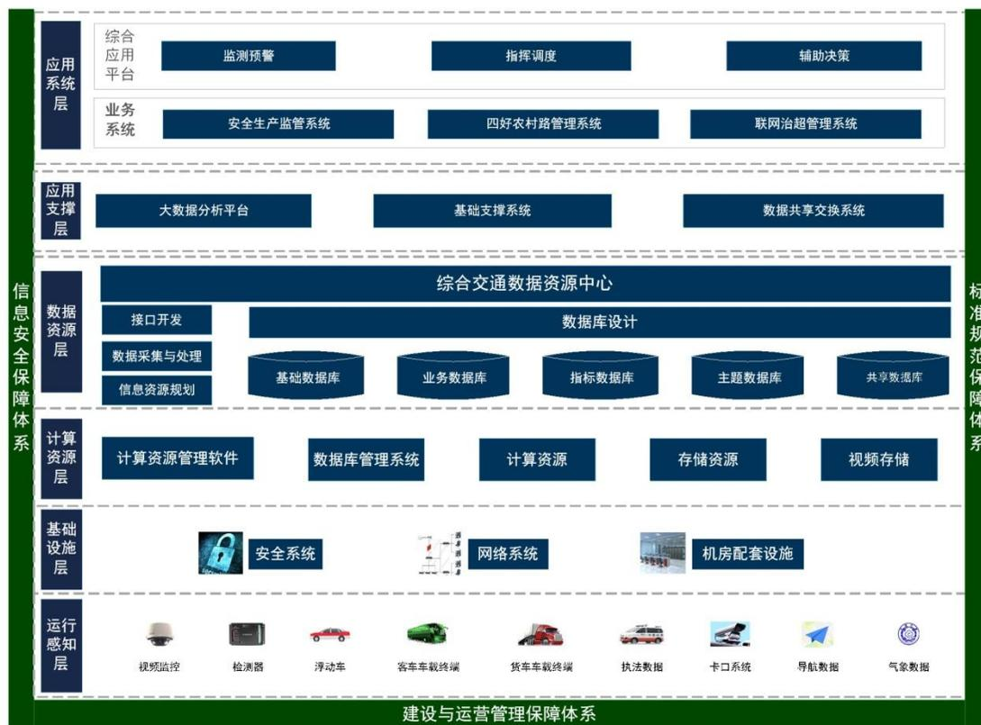
平台总体架构分为六层：运行感知层、基础设施层、计算资源层、数据资源层、应用支撑层、应用系统层。
